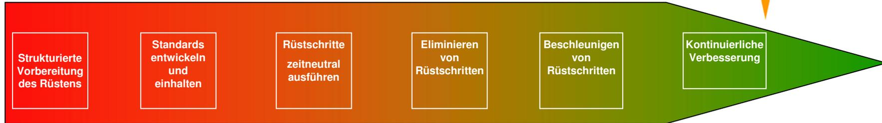
Bereiten Sie den Rüstvorgang im Detail vor und arbeiten Sie mit den standardisierten Checklisten.
